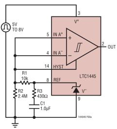
Figure 3a. V<sup>+</sup> Glitching Test Circuit
