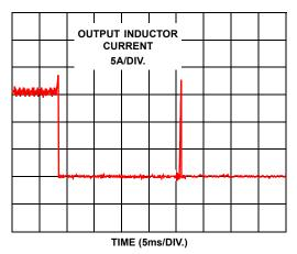
FIGURE 1. OVERCURRENT OPERATION
