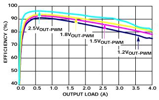
FIGURE 3. EFFICIENCY vs LOAD (1MHz 3.3 VIN PWM)
