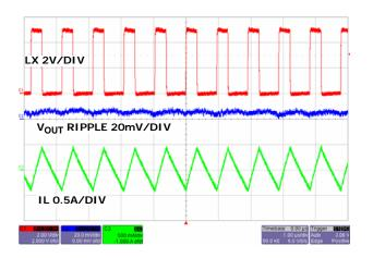
FIGURE 17. STEADY STATE OPERATION AT NO LOAD (PWM)
