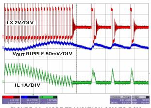
FIGURE 20. MODE TRANSITION CCM TO DCM
