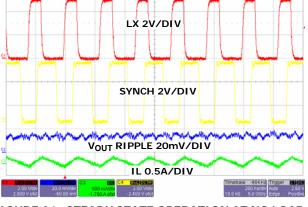
FIGURE 31. STEADY STATE OPERATION AT NO LOAD WITH FREQUENCY = 4MHz
