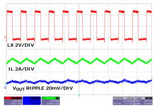
FIGURE 19. STEADY STATE OPERATION WITH FULL LOAD
