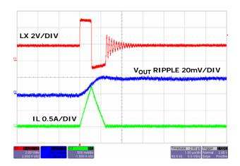
FIGURE 18. STEADY STATE OPERATION AT NO LOAD (PFM)
