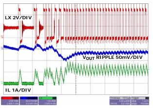
FIGURE 21. MODE TRANSITION DCM TO CCM
