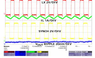
FIGURE 30. STEADY STATE OPERATION AT FULL LOAD WITH FREQUENCY = 2MHz
