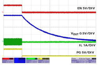
FIGURE 28. SOFT-DISCHARGE SHUTDOWN
