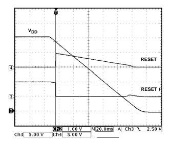
FIGURE 12. RESET AND RESET DEASSERTION
