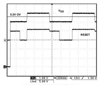
FIGURE 14. 5V OV/UV MONITORING
