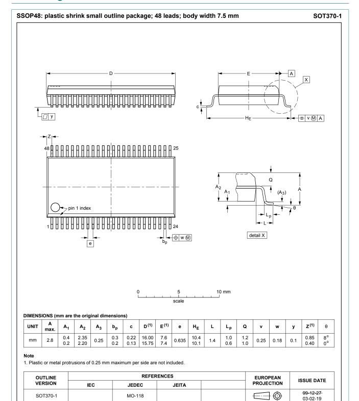
Fig. 8. Package outline SSOP48 (SOT370-1)
