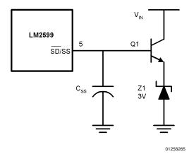
FIGURE 15. External 3.7V Soft-Start Clamp
