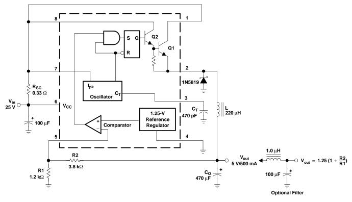
Figure 8. Step-Down Converter
