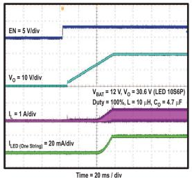
Figure 23. LED DRIVER POWER ON SEQUENCE
