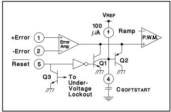
Figure 3. Soft-Start Circuit Schematic
